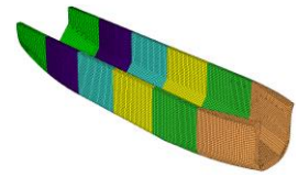
(d) Ballast tanks
